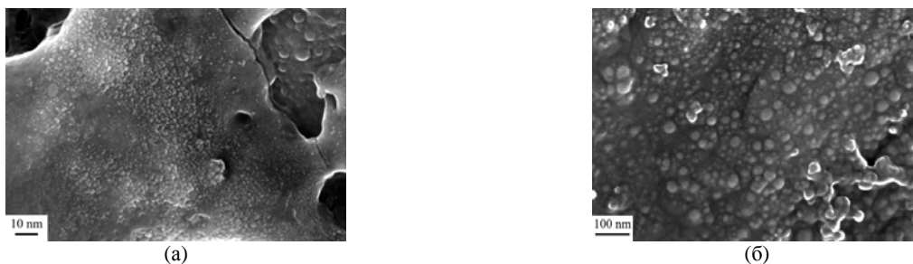
Рис. 7. Микроструктура поверхности покрытия из керамического СВС-электрода с наноразмерной структурой.
