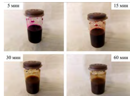
Рис. 8. Изменение цвета раствора во время восстановления \text{KMnO}_4 до \text{MnO}_2 изо -пропанолом при 60^\circ\text{C} .
