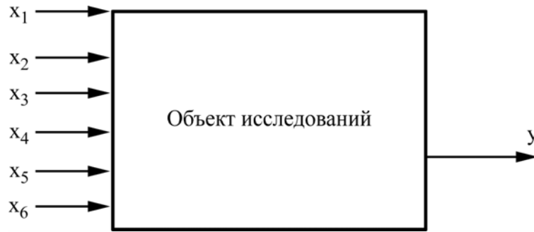
Рис. 1. Схема исследований многофакторного эксперимента: x_1 – запасенная энергия разряда, кДж; x_2 – частота следования разрядов, Гц; x_3 – величина разрядного промежутка, м; x_4 – время обработки, с; x_5 – индуктивность разрядного контура, мкГн; x_6 – удельное сопротивление разрядной среды, Ом·см; y – относительная масса отделенных компонентов.
