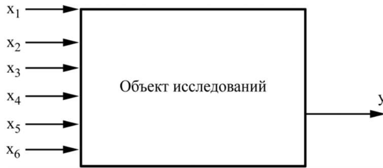
Рис. 1. Схема исследований многофакторного эксперимента: x_1 – запасенная энергия разряда, кДж; x_2 – частота следования разрядов, Гц; x_3 – величина разрядного промежутка, м; x_4 – время обработки, с; x_5 – индуктивность разрядного контура, мкГн; x_6 – удельное сопротивление разрядной среды, Ом·см; y – относительная масса отделенных компонентов.
