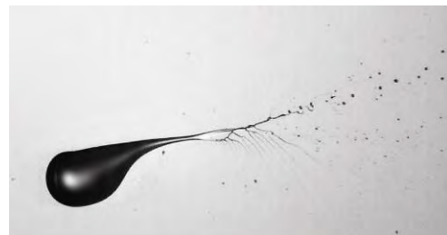
Рис. 1. Фотография струи, неустойчивой по отношению осесимметричной капиллярной волне с m = 2 (режим ветвящихся струй).
