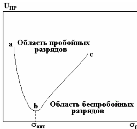
Рис. 2. Качественная зависимость напряжения пробоя межэлектродного промежутка от удельной электропроводности жидкости
