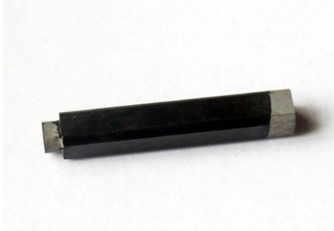
Рис. 9. Деталь, покрытая “черным никелем”
