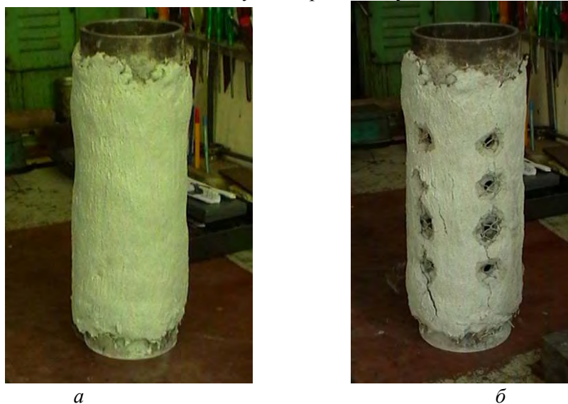
Рис. 2. Внешний вид модели призабойной зоны продуктивного пласта до (а) и после (б) обработки
