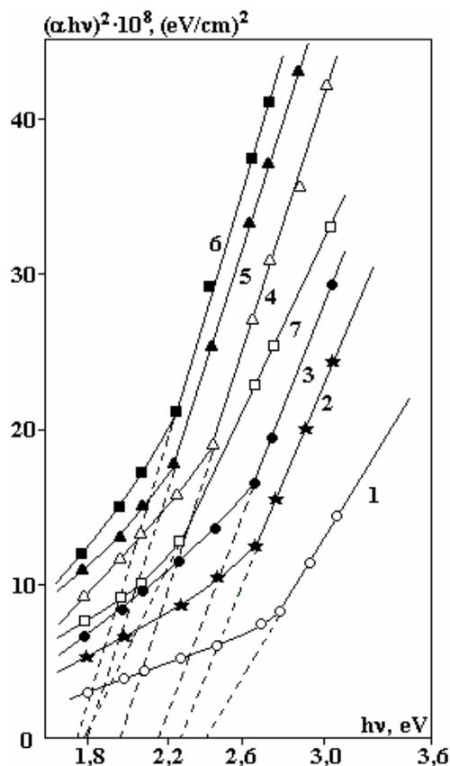
Fig. 3,b. Variation of  $(\alpha hv)^2$  vs  $hv$  for seven film compositions. 1 - 2,42 ( $x = 0$ ); 2 - 2,28 ( $x = 0,01$ ); 3 - 2,17 ( $x = 0,02$ ); 4 - 1,98 ( $x = 0,06$ ); 5 - 1,81 ( $x = 0,08$ ); 6 - 1,75 ( $x = 0,10$ ); 7 - 1,80 ( $x = 0,16$ )
