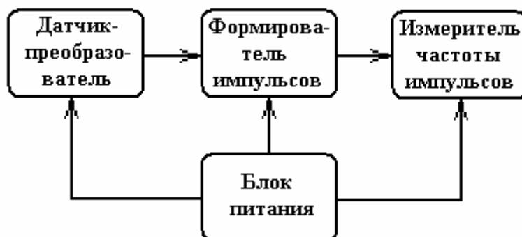
Рис. 2. Блок-схема электронного тахометра
