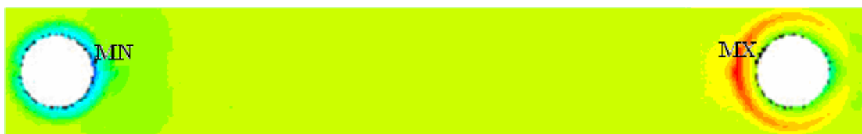
Рис. 5. Контурный график давления (типичная картина для сквозного течения)
