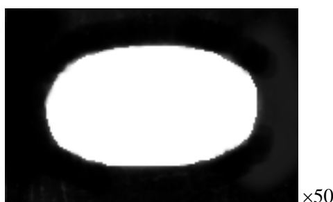
Рис. 3. Кадр скоростной киносъемки дуги
